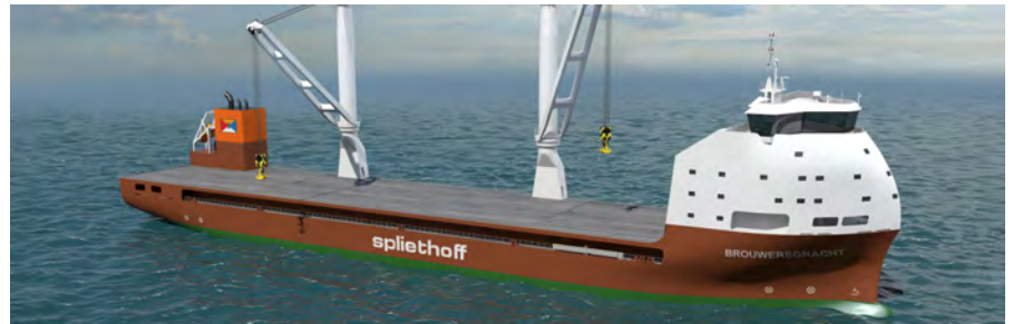
Die Neubauten haben eigene Krane an Deck und die Brücke vorn
